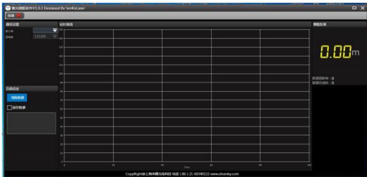
6.5 选择串口号，点击“连接”后，红灯变为绿灯；右侧黄色为测量距离值，数据刷新率也实时显示，实时曲线显示实时距离状态（可滚动鼠标轮调整Y轴范围）；
